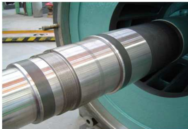
Hřídel vývěvy po renovaci
