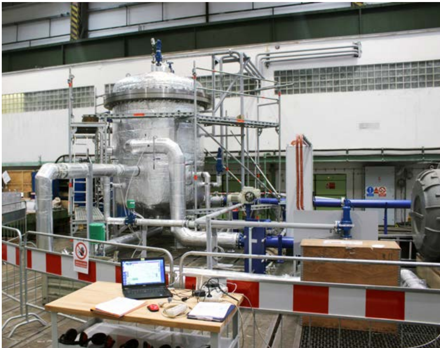
Záběr ze zkoušek prototypu turbočerpádky prováděných ve zkušební smyčce
