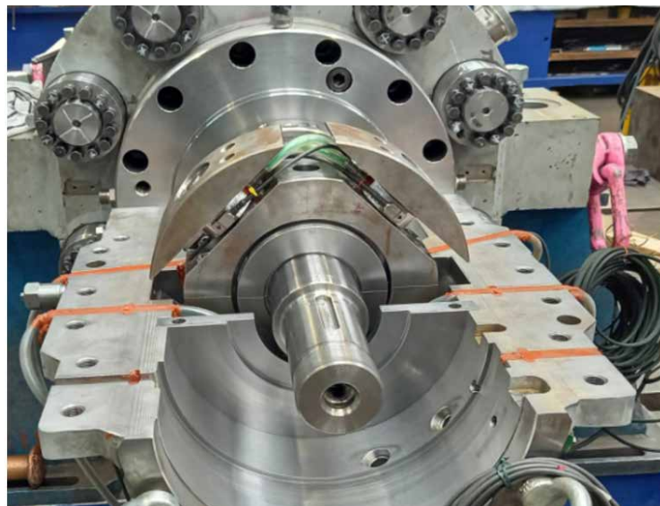
5 Instalace snímačů zatížení radiálního ložiska
