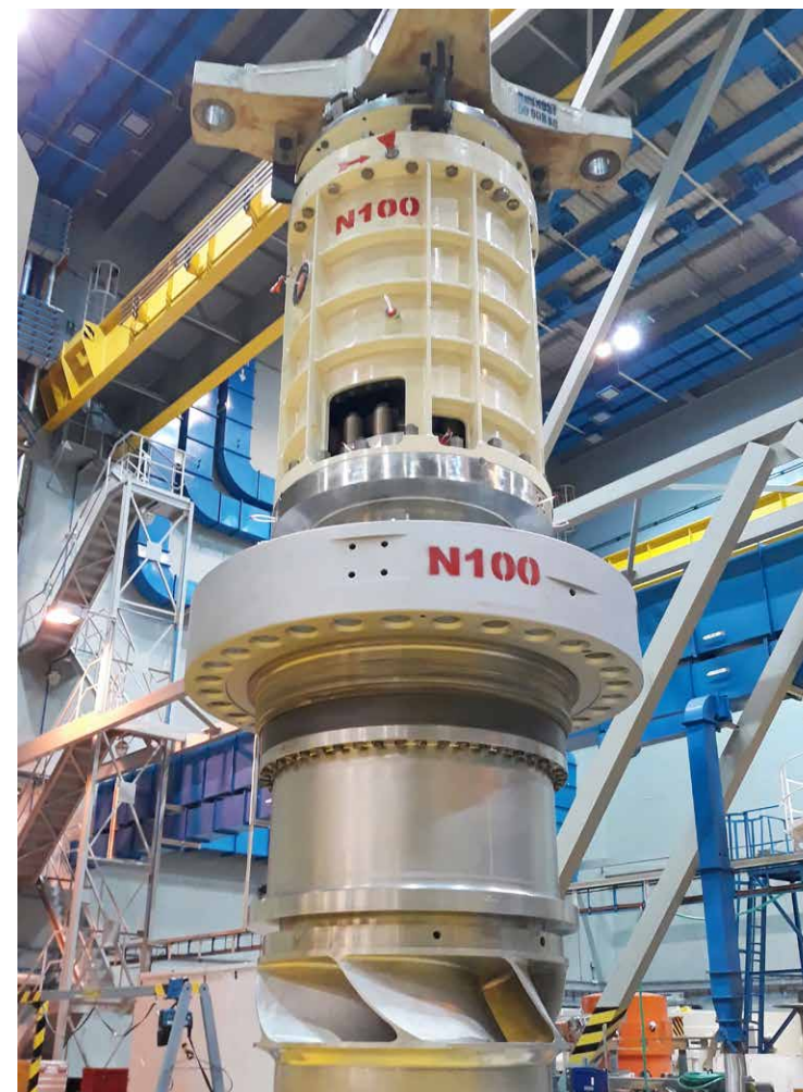
7 Hlavní cirkulační čerpadlo JE Temelín (HCČ)
