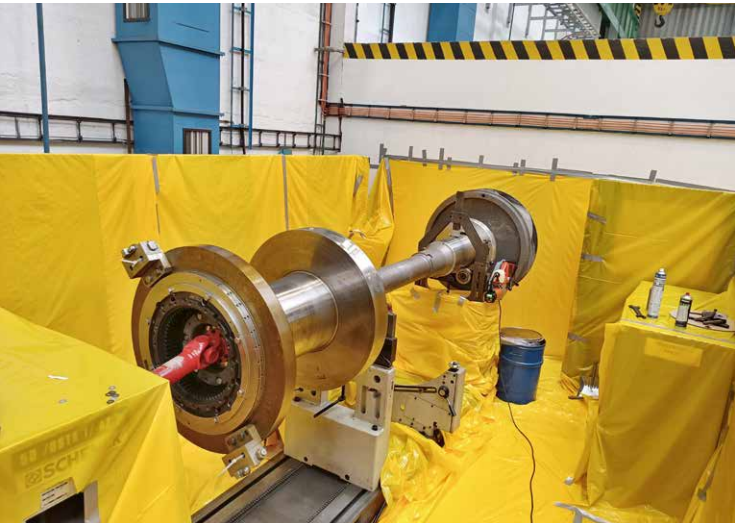
11 Ustavení rotoru do vyvažovacího stroje
