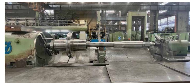
9 Broušení rotoru HCČ po aplikaci žárového nástřiku
